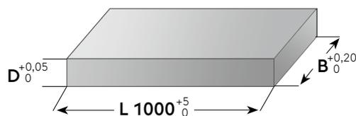
**Präzisionsflachstahl mit Bearbeitungsaufmaß**
