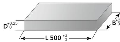
**Präzisionsflachstahl mit Bearbeitungsaufmaß**
