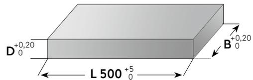
**Präzisionsflachstahl mit Bearbeitungsaufmaß**
