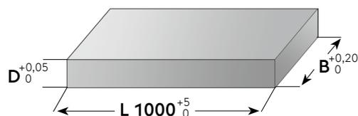
**Präzisionsflachstahl mit Bearbeitungsaufmaß**
