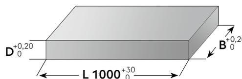
**Präzisionsflachstahl mit Bearbeitungsaufmaß**
