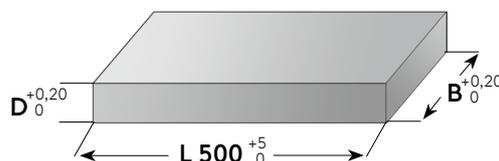
**Präzisionsflachstahl mit Bearbeitungsaufmaß**
