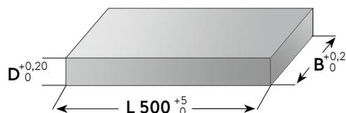
**Präzisionsflachstahl mit Bearbeitungsaufmaß**
