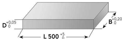
**Präzisionsflachstahl mit Bearbeitungsaufmaß**
