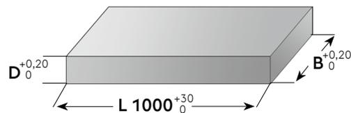
**Präzisionsflachstahl mit Bearbeitungsaufmaß**
