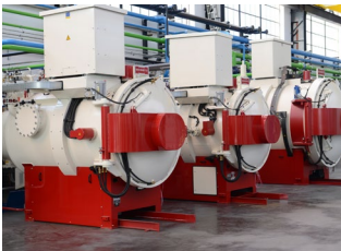
Wärmebehandlungsöfen zum Vakuumhärten
