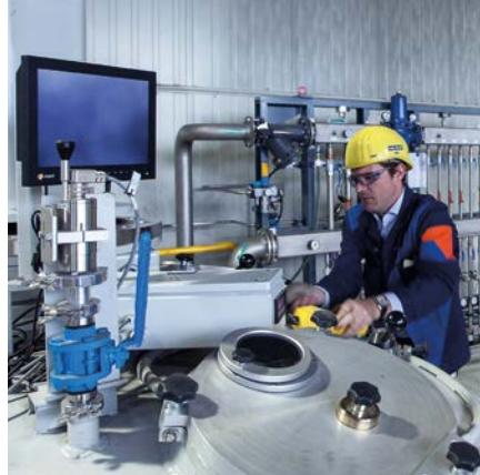
Vakuuminduktionsschmelzen und Verdüsing unter Schutzgas sichern die höchstmögliche metallurgische Reinheit des Pulvers.
